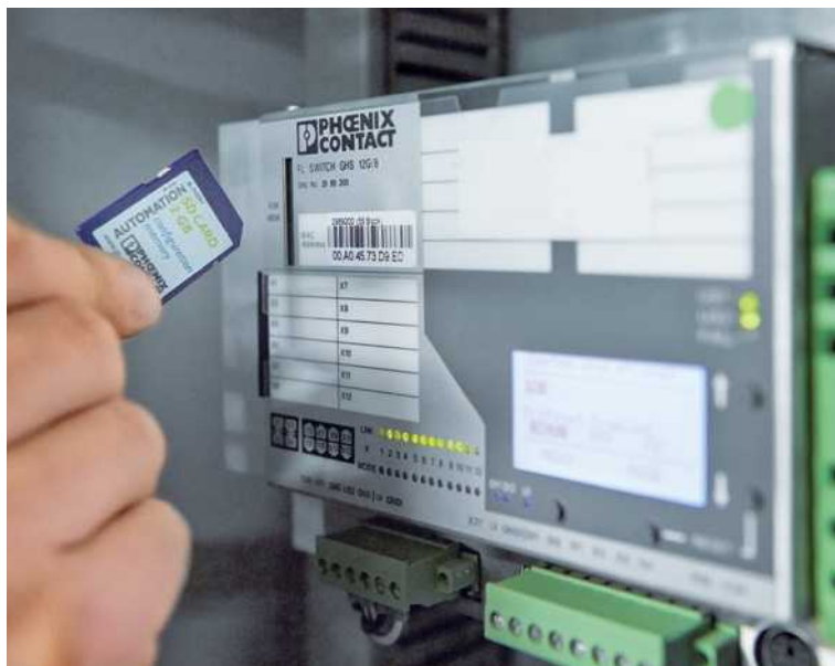
设备特定的配置可以保存在交换机的SD卡上
