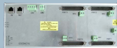
图 5： I/O 设备——EtherCAT 从站
